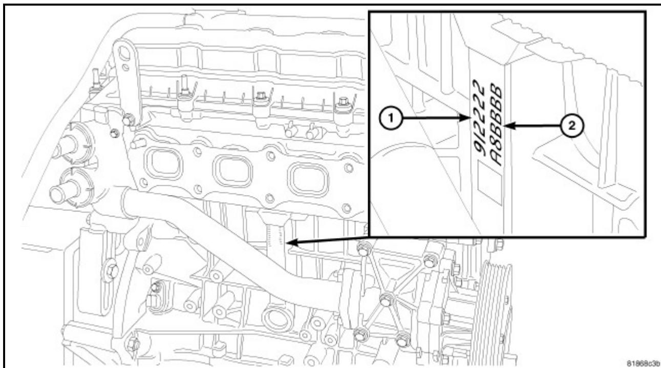
上主轴瓦标识(1)位于发动机右侧缸体的中间。 有三种不同尺寸的轴承。 轴承等级从上向下读，与底部的前轴颈和后轴颈相对应。
